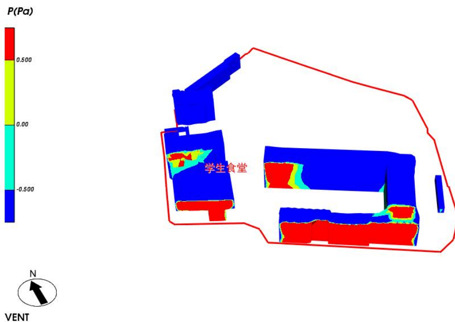
图 5.3- 1 建筑迎风面外窗表面风压云图-夏季
