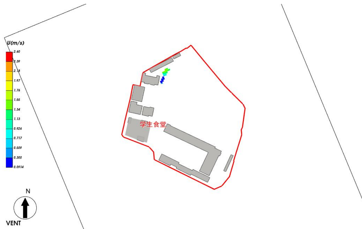
图 5.2- 1 人行区域-1.5 米高度水平面风速云图-冬季
