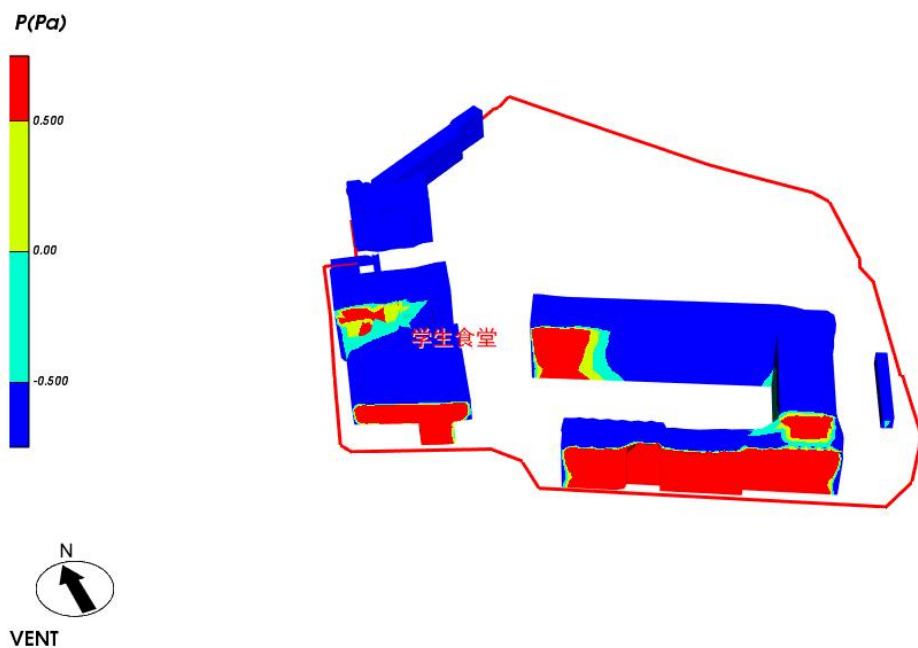
图 5.4- 1 建筑迎风面外窗表面风压云图-过渡季
